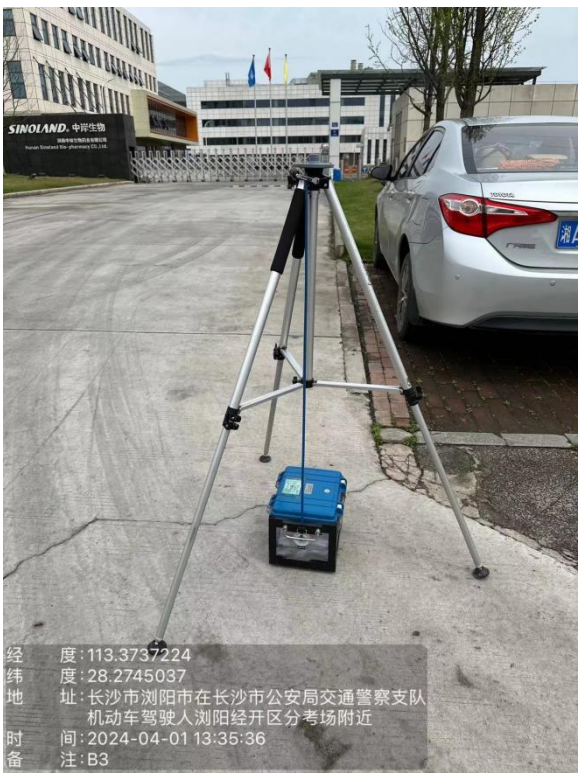
厂界西侧无组织废气采样
